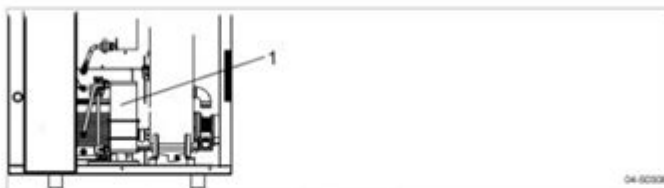
Fig. 10 Sistema de recuperação de calor interno (opção W2/W3)
